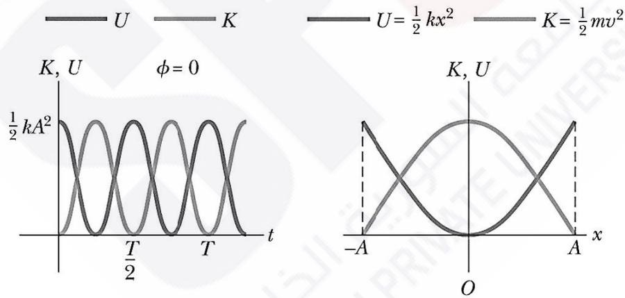
الشكل (7-2-1) (أ) - الطاقة الحركية والطاقة الكامنة كتابع للزمن للحركة التوافقية البسيطة عند  $\phi = 0$ . (ب) - الطاقة الحركية والكامنة كتابع للموضع للحركة التوافقية البسيطة. وكلا الشكلين يبين انخفاض مجموع الطاقين  $U + K$
